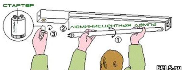
Схема включения лампы дневного света
